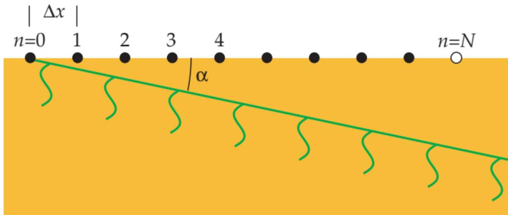
Soit une onde harmonique  $A \sin \omega t$ , incidente au géophone 0 avec une vitesse  $V$ ;
